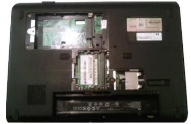
**Paso 2:** Después retire el tornillo de seguridad que se encuentra sobre la cubierta interna del equipo (comúnmente incorporado por muchos fabricantes, cuya finalidad es asegurar las cubiertas de la laptop).
