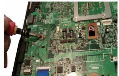
**Paso 4:** Extraiga posteriormente toda la placa, procurando tener cuidado para no romper algún puerto del onboard. Una vez fuera, colóquela sobre una bolsa antiestática. Verifique la posición de ajuste para su colocación en el futuro.
