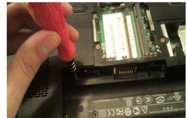
**Paso 3:** Una vez retirados los tornillos que sujetan el teclado, dé vuelta el equipo y proceda a retirar el dispositivo suavemente. Para hacerlo, verifique en primera instancia que este se encuentre conectado desde el interior mediante un cable plano FFC y un conector ZIF.
