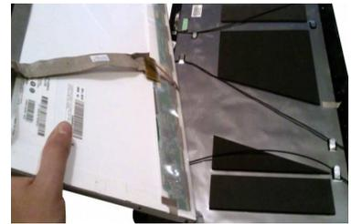
Una vez concluido el desensamble de nivel 2, realizar el ensamble en el orden inverso en el que se realizó el desensamble, una vez concluido realizar el ensamble de nivel 1, y después realizar una prueba de funcionamiento, es decir, encender la computadora y verificar que entre corriente a la notebook con el cargador.
