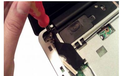
**Paso 4:** Posteriormente, con la ayuda de una púa plástica triangular o una punta trazadora (punta plana de plástico), proceda a sacar la cubierta superior. Para hacerlo, sujete la púa y deslícela sobre todo el contorno de la computadora. Verá cómo comienza a desprenderse dicha cubierta de la base del equipo portátil.
